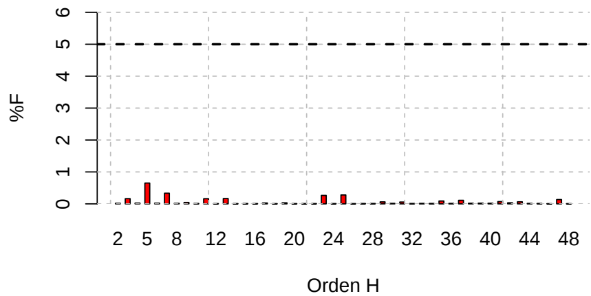
Armónicas en Voltaje L2
